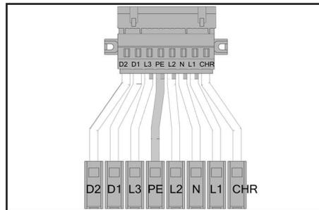
Ausgangsbuchsenbelegung entsprechend umgekehrt, siehe Aufdruck
